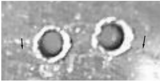
图 8 左孔洞外侧裂纹扩展的同时右孔洞外侧裂纹也开始扩展
