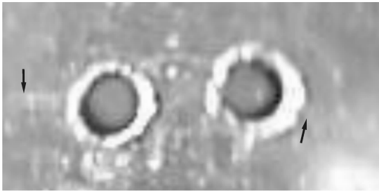
图 7 孔洞聚合后,左孔洞外侧裂纹向左扩展
