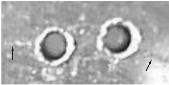
图 9 左、右孔洞的外侧裂纹同时继续扩展
